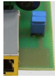
Rys. 3 Tryb aktywny – zasilanie jest przenoszone
