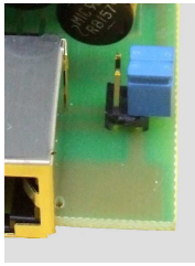
Rys. 2 Tryb zwykły – brak zasilania DC
